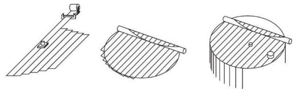
Abb.19 Vorfertigung der Membran im Werk
