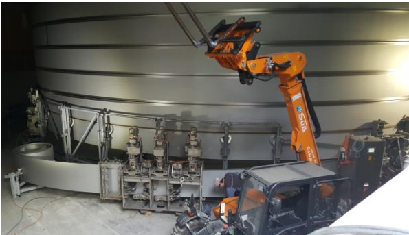
Abb.25 LIPP Behältermaschine im Einsatz
